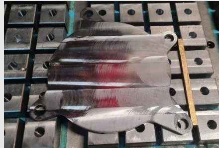
Platte – Planfräsen Werkstoff – Stahl Aufspannung mit Elektromagnet Ideal für unregelmäßige Formen
